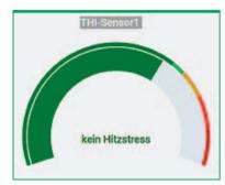
Aus Echtzeitdaten kann der Temperature-Humidity-Index berechnet und die Lüftung im Stall angepasst werden.
