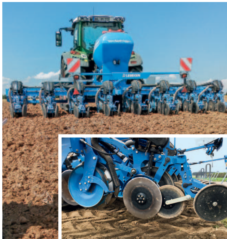
Lemken Azurit 9 , Bj. 2019, Arbeitsbreite 6 m, 8 Reihen, keine Highspeed, Zusatzausstattung: Isobus, MegaSeed, Düngerschare, hydraulische Scharndruckverstellung, elektrische Abstreiferfernverstellung, Säaggregat mit vorlaufender Trapezpackerwalze (unteres Bild).
